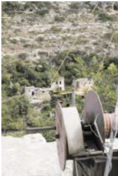
Materiaalien kuljetusta tavernaan on helpotettu sähkökäyttöisellä vajjeriradalla jossa päivittäiset tarvikkeet kulkevat helpommin.
